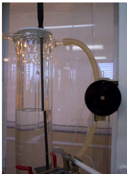
Figura 2. Detalle del cilindro de ajuste fino y poleas de ajuste de nivel.
