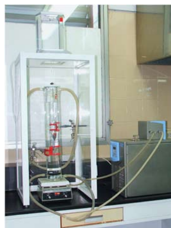
Figura 4. Imagen del equipo construido y armado para la calibración de densímetros.
