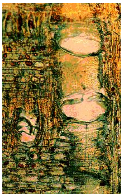
Figura 2. Corte radial, radios homogéneos X250 A
