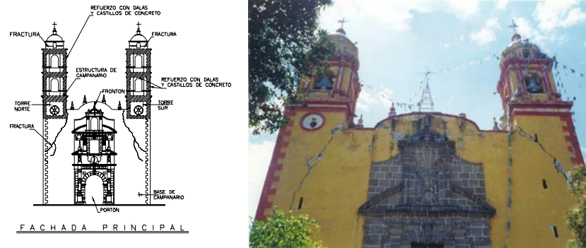
Figura 21. Refuerzo de torres de campanario con concreto armado
