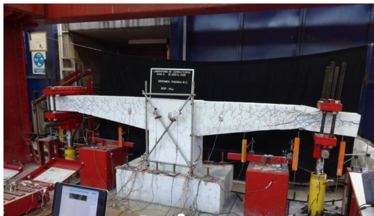
Figura 25. Falla en el vértice de la cartela derecha del espécimen TASCV3α4-R1c
