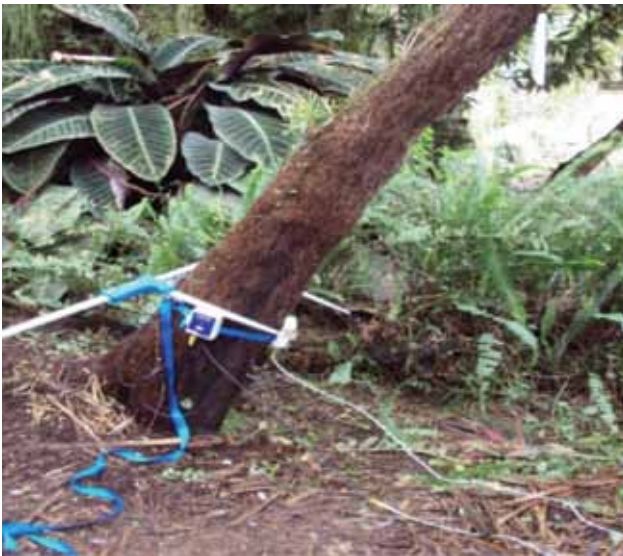
Figura 3. Estipe de Dicksonia squarrosa (G Forst.) Sw. con forcípula Hafglöf y sensores Picus.
