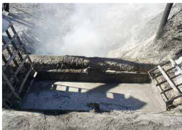
Figura 4. Caldero de hierro denominado "paila", en donde se lleva a cabo el proceso de extracción de cera de candelilla.
