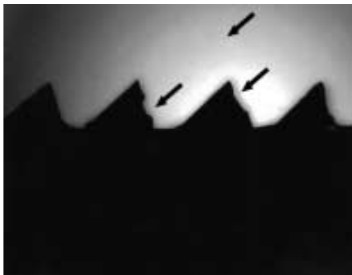
Figura 8 – Detalhe da projeção de perfil de parafuso ósseo, apresentando duas roscas adjacentes com irregularidades em sua superfície (setas).
