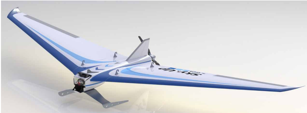
Figura 2. Configuración preliminar del diseño de la góndola aerodinámica recuperable. Fuente: elaboración del autor.
