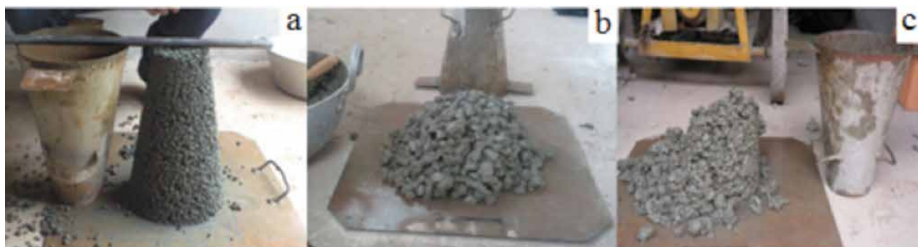
Figura 1. Ensaio do Slump no CoPe com agregado (a) B0, (b) B1 e (c) 50B0/50B1
