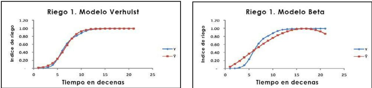
Figura 2. Indicadores de riego estimados y observados del Riego 1 en los modelos Verhulst y Beta. Elaboración propia.
