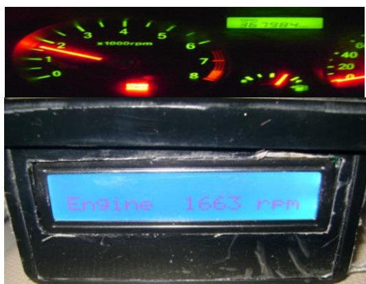
Figura 10 Comparación del valor analógico del automóvil con el valor digital de la solución propuesta
