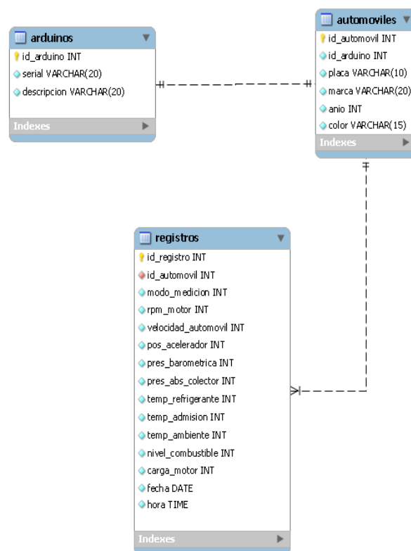
Figura 6. Diagrama relacional de base de datos para el bloque de almacenamiento
