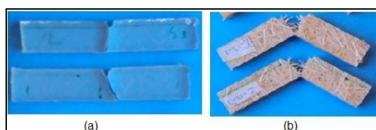
Figura 16. (a) Matriz de PLA, (b) fibra corta de 10 mm al 13 vol%.
