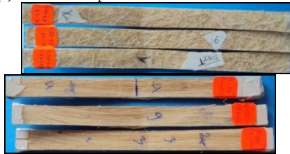
(b) Fractura incompleta de las probetas de material compuesto.
