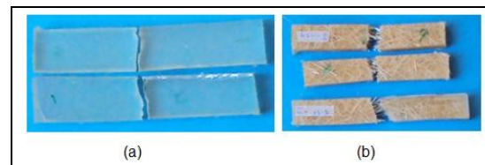
Figura 15. (a) matriz de PLA, (b) fibra corta de 10 mm al 13 vol%.
