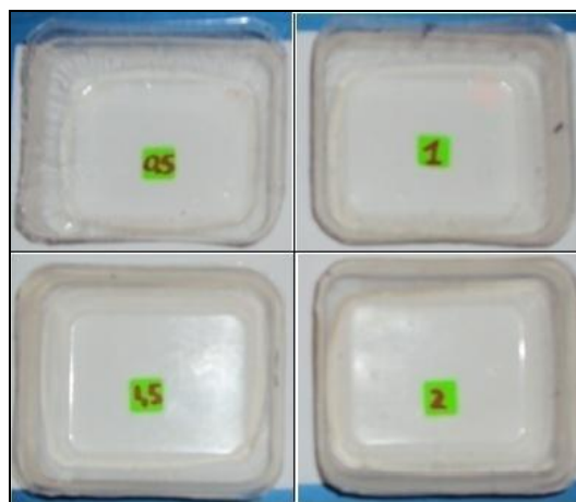
Figura 20. Prototipos de PLA elaborados con láminas de 0,5; 1,0; 1,5 y 2,0 mm.
