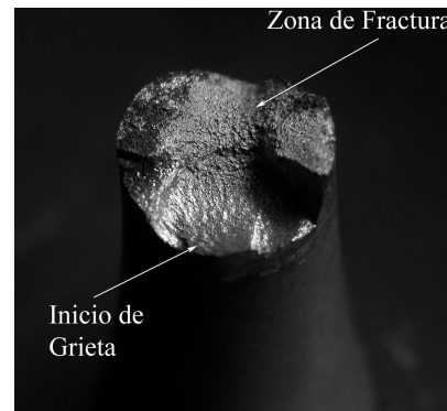
Figura 7: Macrografía del Acero AISI 1045. Condición normalizado sometida a fatiga de bajo ciclaje ( S=384 Mpa).
