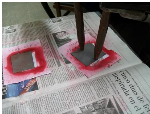
Figura 1: Imanación por electrodos de la chapa de acero al momento de aplicar corriente magnetizante
