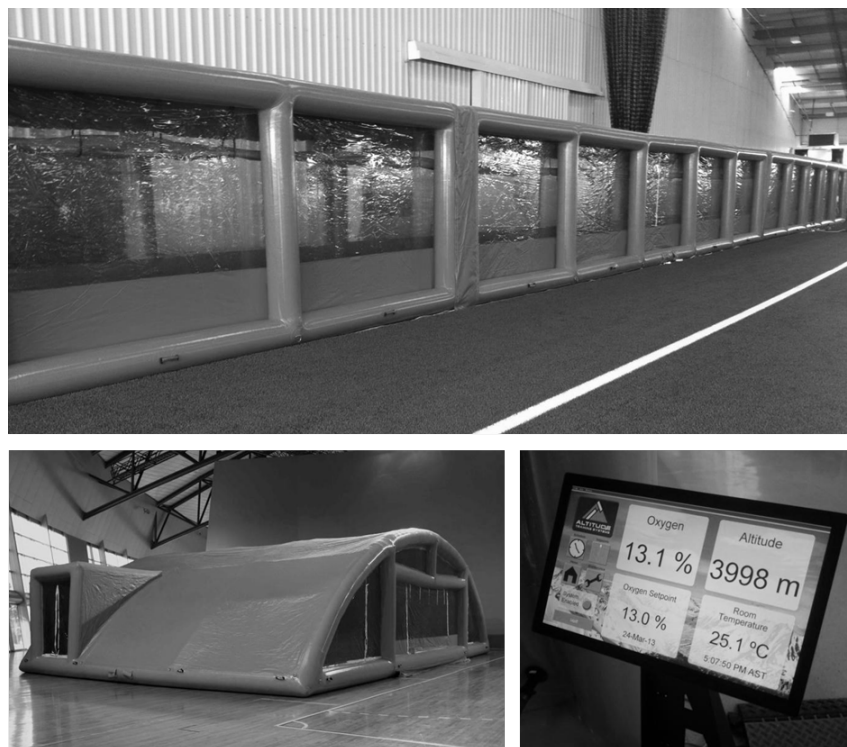
Figura 1. Presentación del sistema de hipoxia simulada inflable móvil. Túnel externo (panel superior), diseño rectangular (panel inferior izquierdo) y controlador de pantalla táctil (panel inferior derecho).
