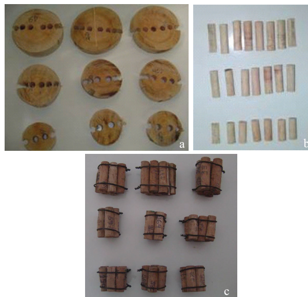
Figura 2 – Esquema da retiradas das amostras radiais nos discos (a), amostras (b) e feixes para carbonização (c).
