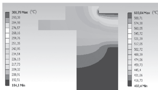
Figura 5. Imagen del perfil de distribución de la temperatura a t=1h para dos referencias: 300 °C (izquierda) y 600 °C (derecha).
