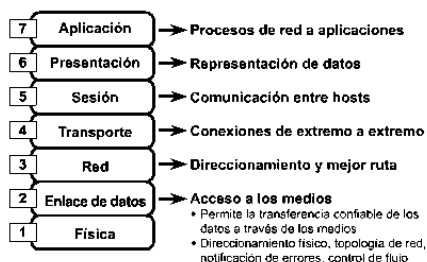
Figura 4. las siete capas del modelo OSI, y detalla, las funciones de la capa 2. fuente : Cisco (2003)
