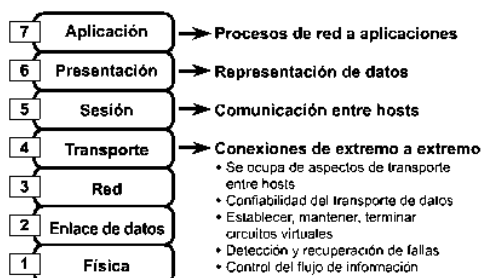
Figura 6., las siete capas del modelo OSI, y detalla las funciones de la capa 4. Fuente Cisco (2003)
