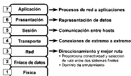
Figura 5. las siete capas del modelo OSI, y detalla, las funciones de la capa 3. fuente : Cisco (2003)
