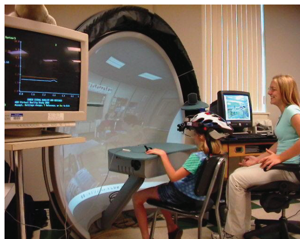
Figura 1: Niño en un ambiente virtual de alta inmersión, usando casco virtual y rastreador de posición (VR Classroom, 2007).
