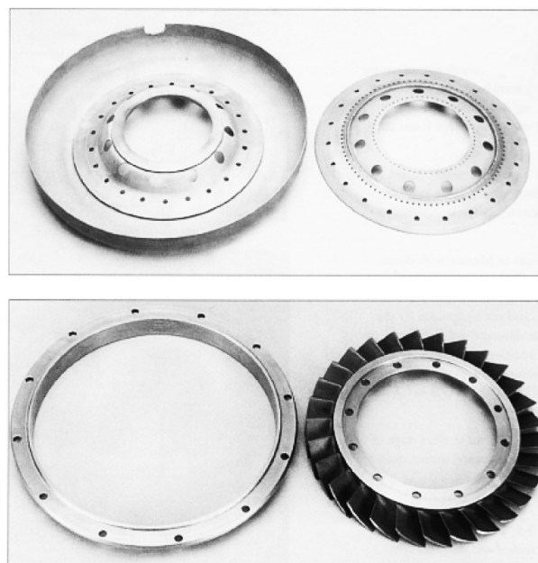
Figura 6: Pás de turbinas a gás produzidas com superligas ODS de níquel
