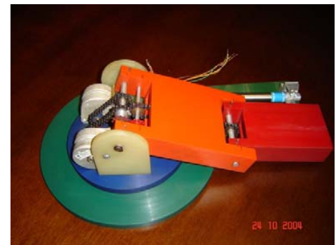
Figura 7. Disposición constructiva del manipulador.
