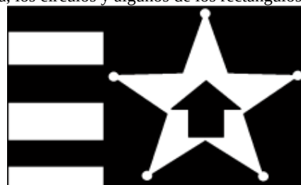
Figura 7. Imagen binaria generada a partir del método del promedio con un umbral global de 69. [Los autores]
