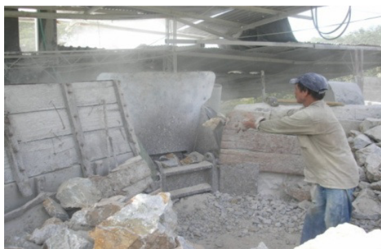
Figura 2. Alimentación manual en la etapa de trituración primaria.
