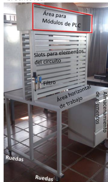
Figura 10. CAD (a) y banco construido (b).
