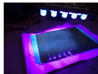
Figura. 14. Fijación de película protectora con luz UV
