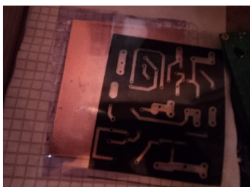
Figura. 11. Baquelita de fibra de vidrio con acetato impreso
