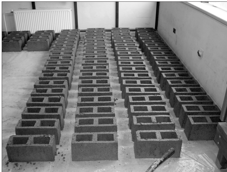
Figura 3. Fabricación de bloques de hormigón
