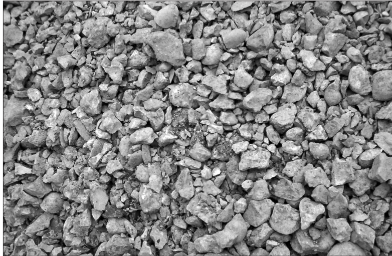
Figura 2. Árido reciclado después de la trituración
