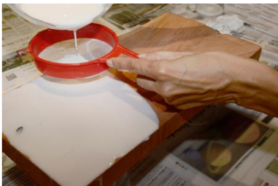
FIGURA 4 Aplicación de emulsión con colador.
