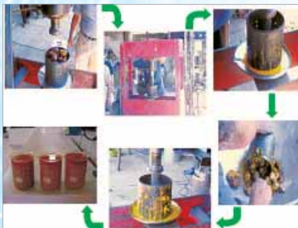
Figura 3. Proceso de extracción de aceite de Moriche por presión en frío.
