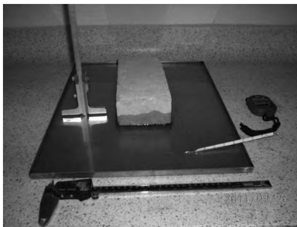
Figura 4. Ensayo de Tasa inicial de absorción en ladrillos. (Laboratorio Resistencia de materiales y sísmica UFPSO)
