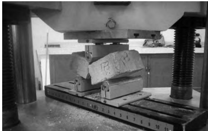
Figura 3. Ensayo de flexión en ladrillos (Laboratorio de resistencia de materiales y sísmica UFPSO)
