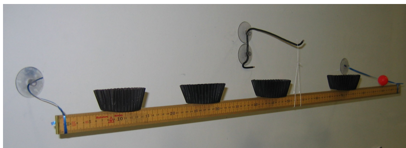
Figura 2. Configuración para soltar en forma simultánea los moldes de papel.
