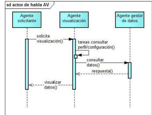
Figura 12: Diagrama de interacción del AV
