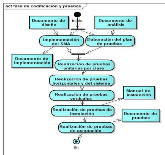
Figura 8: Flujo de trabajo de la fase de Codificación y Pruebas
