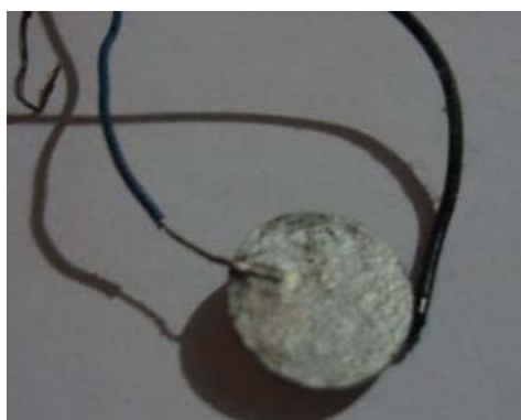
Figura 2. Foto del \text{Bi}_4\text{Ti}_3\text{O}_{12} con pintura de plata y colocación de electrodos.
