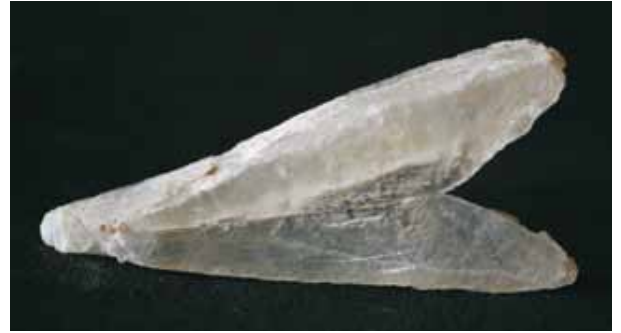
Figura 40. Maclas de yuxtaposición simple de yeso, en forma de punta de flecha.
