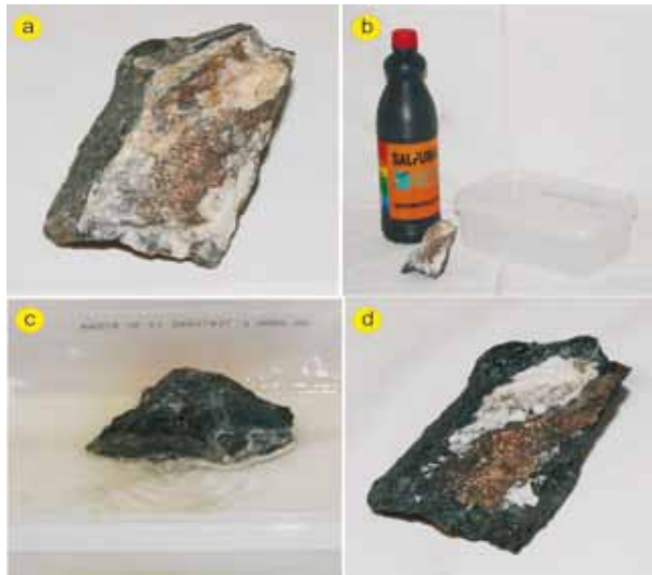
Figura 112. Limpieza de muestra rica en carbonatos con ayuda de ácido clorhídrico o sulfamán. a) Imagen de la muestra natural donde hay pirrotina (de color bronce) incluida en calcita (blanco). b) Cubeta donde se hace el ataque ácido. c) Ataque con ácido de la muestra y destrucción de la calcita que desprende \text{CO}_2 , con efecto efervescente. d) Muestra ya atacada donde resalta mucho más la pirrotina.
