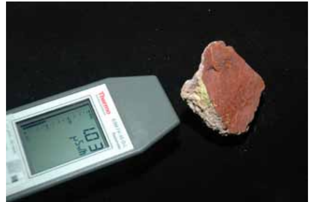
Figura 90. Radioactividad de una muestra de autunita (cristales amarillos) medida con la ayuda de un escintilómetro.
