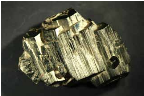
Figura 92. Cristales cúbicos de pirita, con brillo metálico y color latón.
