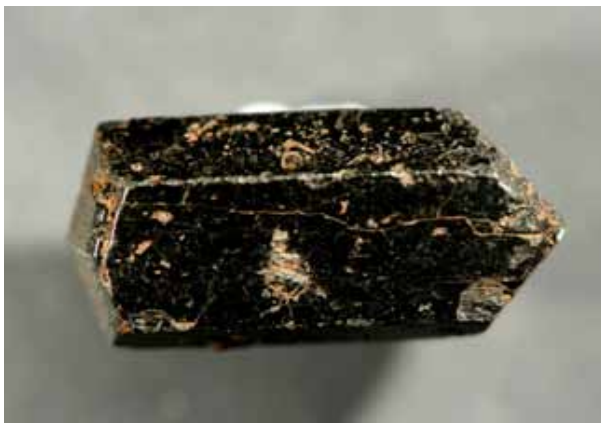
Figura 12. Cristal idiomórfico de hornblenda de hábito prismático. Tenerife (Canarias).
