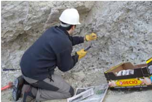
Figura 107. Extracción de los cristales de pirita de la imagen anterior con ayuda de escarpa y martillo.
