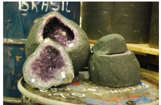
Figura 17. Crisales de amatista (morado) de Brasil que tapizan geodas en basalto alterado de color verde. Las geodas han sido serradas para mostrar mejor las cristalizaciones.
