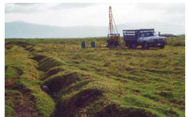
Figura 3. Fotografía de la planicie lacustre de Chalco. En primer plano se observa una fractura de varias decenas de longitud en la zona de estudio con orientación N10E.
